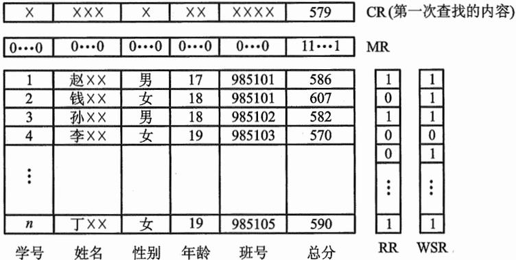
图 4.82 相联存储器检索举例
